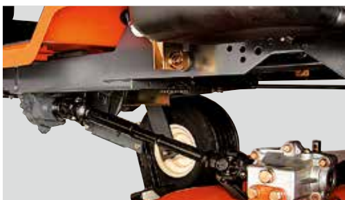
Robusten kardanski pogon z zaščitno napravo
